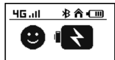
Batterie complètement chargée
