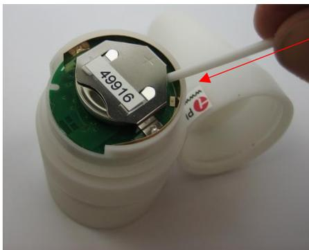
Die Batterie wird vorsichtig aus der Halterung geschoben, zum Beispiel mit einem Wattestäbchen oder einem Feuerstab.
