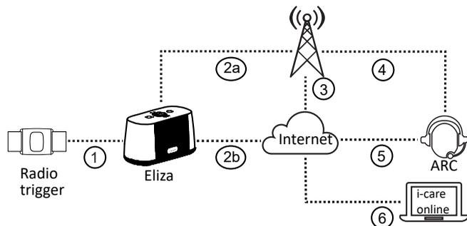
1. Activación del mando a distancia de alarma por radio o por cable.
